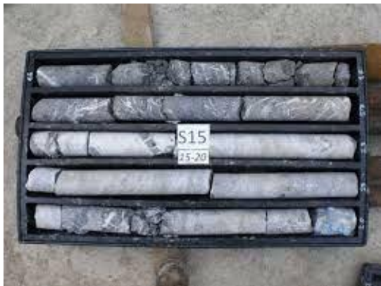
Carote di sondaggio nelle cassette portacampioni
