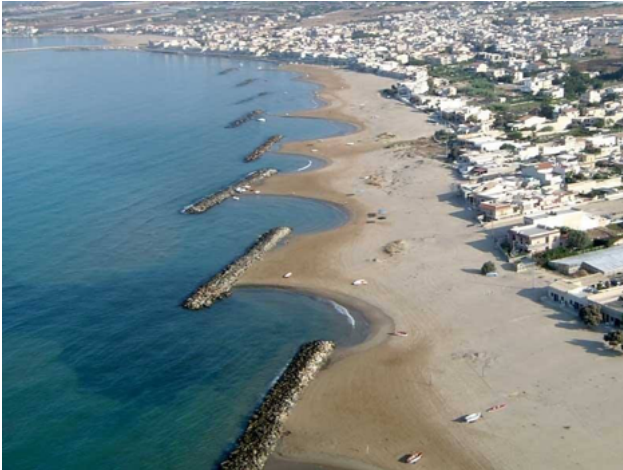
Scogliere e murazzi per contrastare l'erosione delle spiagge
